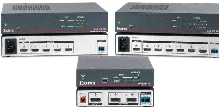
La serie DA HD 4K de amplificadores de distribución de Extron divide una señal fuente HDMI y la envía a varias salidas simultáneamente, ofreciendo amplificación y mejora para mantener su calidad. Todos los modelos soportan señales de vídeo a resoluciones de hasta 4K, y ofrecen características de fácil integración para asegurar el funcionamiento fiable en aplicaciones de AV profesional.
